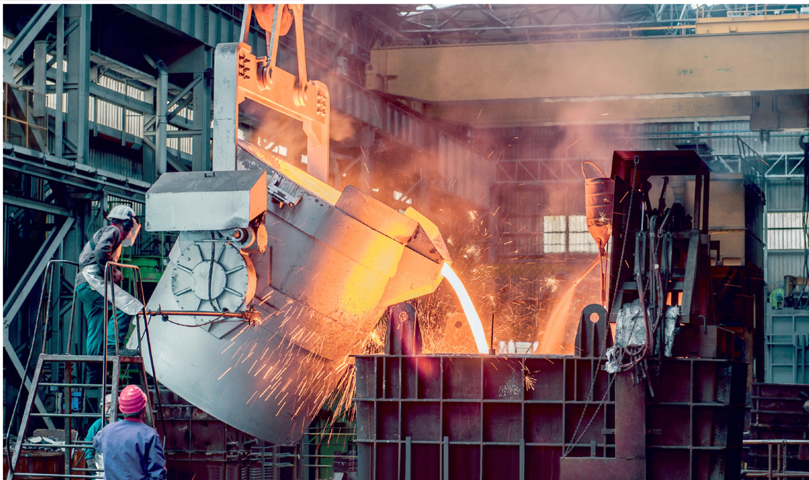
Il reparto di formatura automatica di FMG (a sinistra) e la fase di colata di un getto da oltre 100 tonnellate (sopra)
