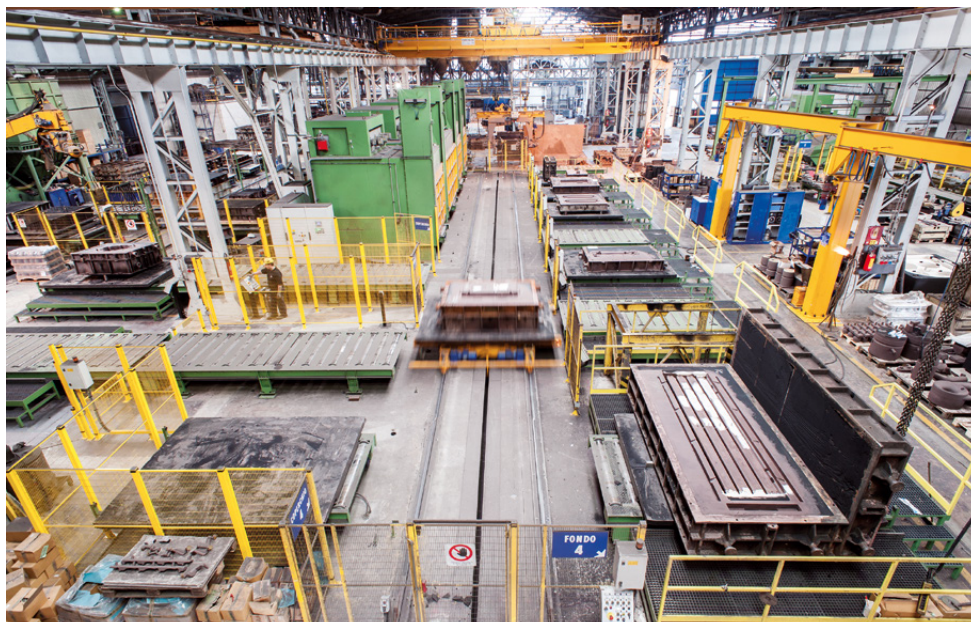
L'impianto di formatura per prodotti fino a otto tonnellate
