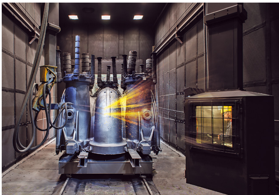
Fasi di pulizia finale di un prodotto di dimensioni superiori alle 70 tonnellate
